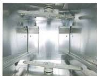
上下に装着されたストレートノズル
