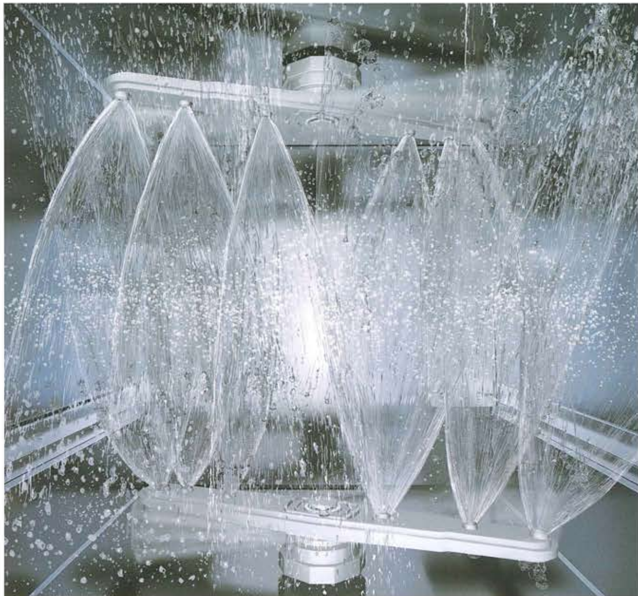
ストレートノズル水流噴射イメージ
